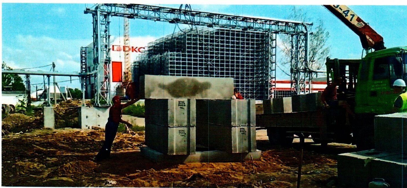
Фото 7 – Первый этап испытаний – нагружение до нагрузки 12,5 тонн
