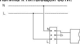
2. Схема подключения светильника к питающей сети с регулируемым драйвером по системе DALI.
