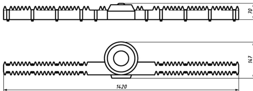
*Рис. 1. Внешний вид устройства защиты от птиц PDO-2.*
