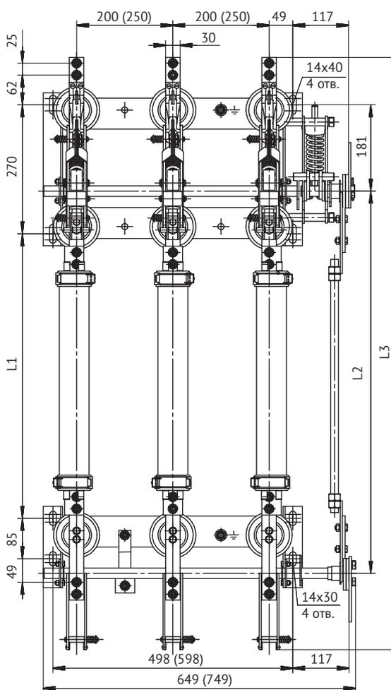
Выключатель нагрузки ВНА-10/630-Ппр-з-И2-У2
