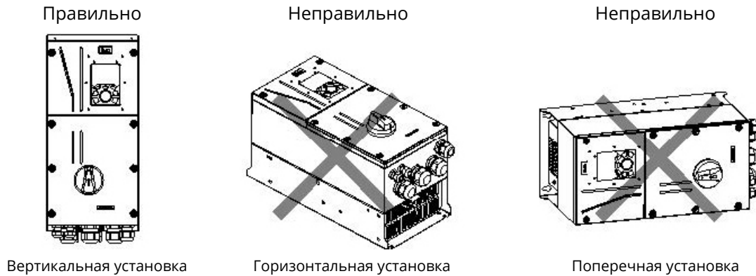
Рис 4.1 Ориентация ПЧ при установке
