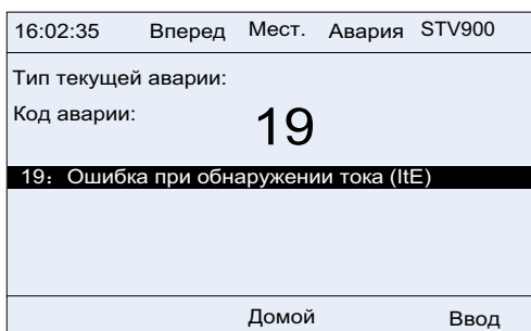
Рис 5.7 Состояние дисплея при сигнализации неисправности ПЧ
