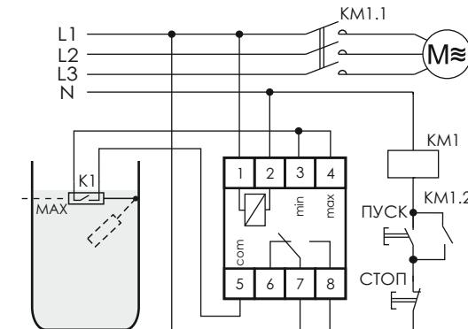
Установлена перемычка между клеммами 3 и 4. Если уровень ниже «MAX» - замкнуты контакты 7-8, насос включен. Если уровень выше «MAX» - контакт K1 поплавкового датчика замыкаются и насос отключается.
