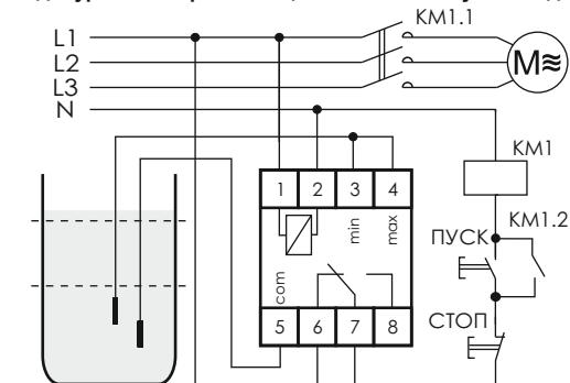
Установлена перемычка между клеммами 3 и 4. При наличии жидкости в резервуаре замкнуты контакты 6 и 7 и насос можно включить в работу кнопкой «ПУСК». При отсутствии жидкости между электродами, контакты 6 и 7 размыкаются и насос отключается.
