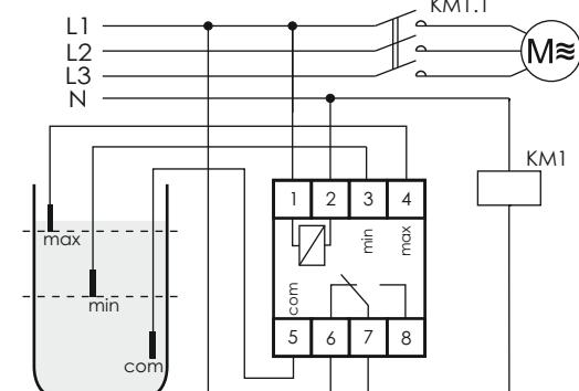
Если жидкость на уровне «MAX» контакты 6-7 замкнуты, насос включен и происходит откачивание из резервуара. При снижении уровня ниже «MIN» контакты 6-7 размыкаются, насос отключается. После наполнения до уровня «MAX» контакты 6-7 замыкаются, насос включается и цикл работы повторяется снова.
