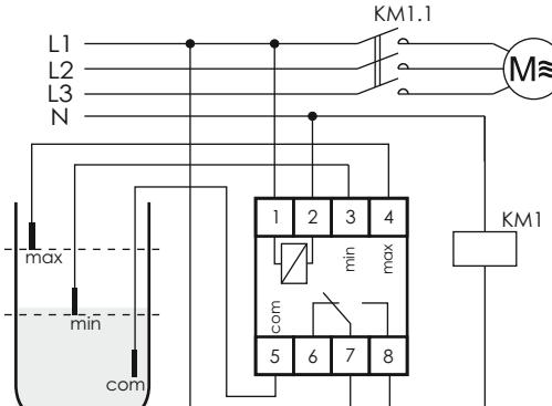
Если уровень ниже «MIN», контакты 7-8 замкнуты, насос включен и происходит наполнение резервуара. При достижении уровня «MAX» контакты 7-8 размыкаются, насос отключается. При снижении уровня ниже «MIN» контакты 7-8 замыкаются, насос включается и цикл работы повторяется снова.
