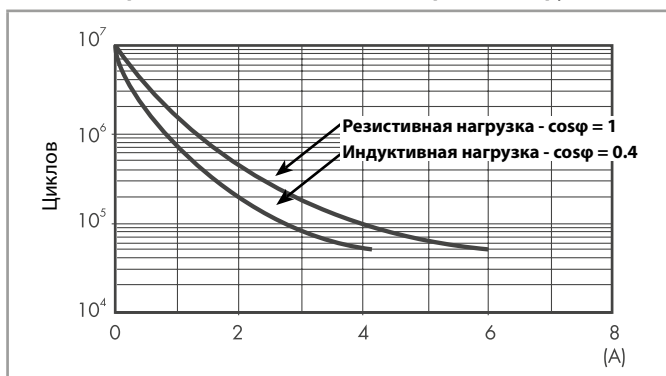
F 32 - Электрическая долговечность (AC) при ном. нагрузке
