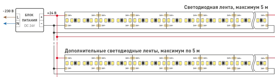
Схема 2. Подключение нескольких светодиодных лент с двух сторон.
