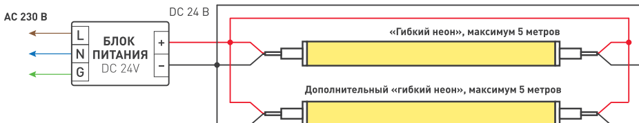
Схема 1. Подключение «гибкого неона»
