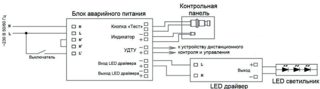
Рисунок 2 – Схема подключения БАП для работы в основном режиме
