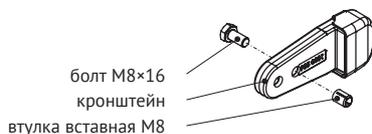
корпус кронштейна OptiBox G-UMO-K3
