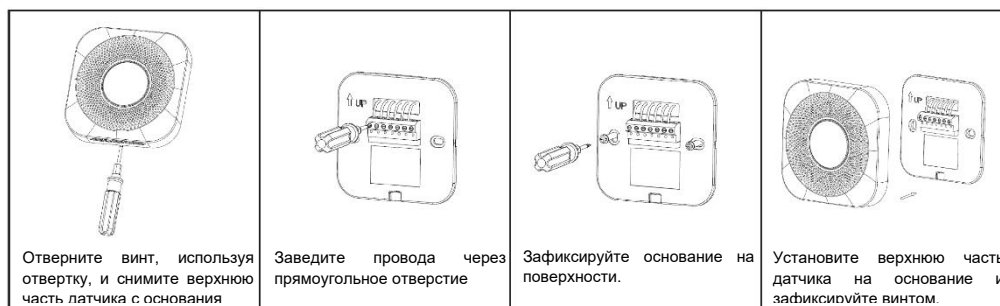
Порядок установки датчика качества воздуха
