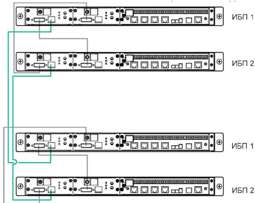
Рисунок 17-19. Синхронизация между двумя системами ИБП для двух отдельных ИБП Для двух параллельных ИБП
