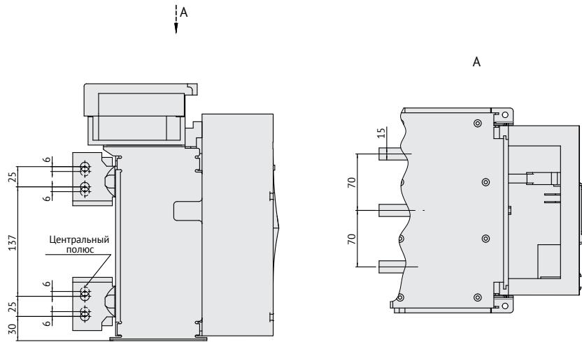
**Рисунок А.2** – Автоматический выключатель OptiMat A-630-1600-S1 стационарного исполнения на номинальные токи 630 – 1600 А с вертикальным расположением выводов
