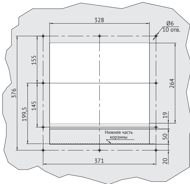
**Рисунок А.9** – Вырез в дверце для автоматического выключателя OptiMat A-5000-S5, OptiMat A-6300-S6 выдвижного исполнения
