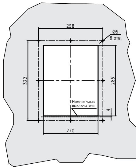
**Рисунок А.3** – Вырез в дверце для автоматического выключателя OptiMat A-630-1600-S1 стационарного исполнения
