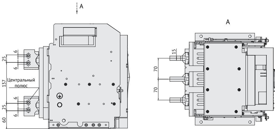
**Рисунок А.5** – Автоматический выключатель OptiMat A-630-1600-S1 выдвижного исполнения на номинальные токи 630 – 1600 А с вертикальным расположением выводов
