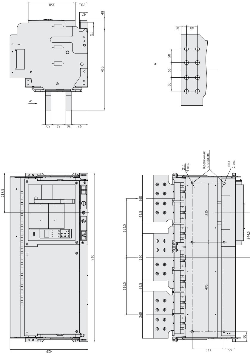
**Рисунок А.8 – Автоматический выключатель OptiMat A-6300-S6 выдвижного исполнения на номинальный ток 6300 А**
