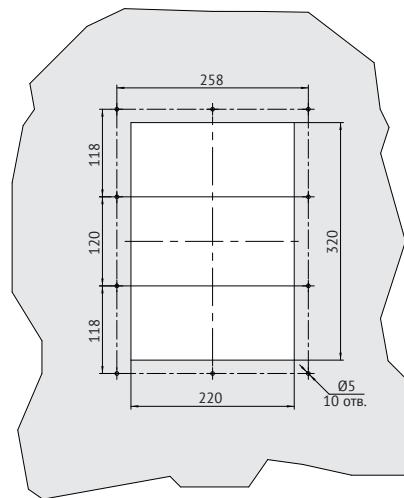
**Рисунок А.6** – Вырез в дверце для автоматического выключателя OptiMat A-630-1600-S1 выдвижного исполнения
