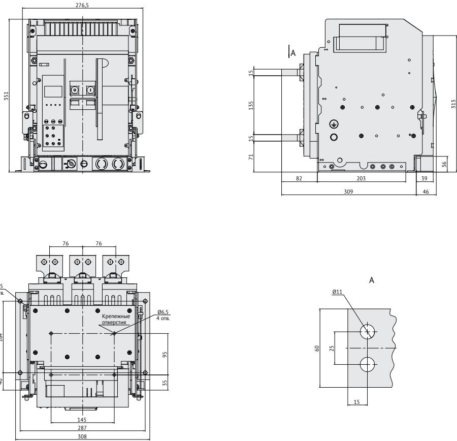
**Рисунок А.4** – Автоматический выключатель OptiMat A-630-1600-S1 выдвижного исполнения на номинальные токи 630 – 1600 А с горизонтальным расположением выводов
