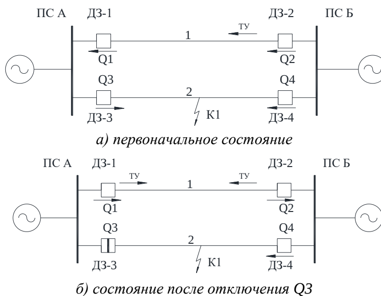
Рисунок 13 - Реверс мощности при отключении КЗ на параллельной линии
