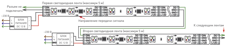
Рис. 1. Схема подключения ленты без использования внешнего контроллера [максимум 1024 пикселя, общий рисунок динамического эффекта при переходе с ленты на ленту сохраняется].
