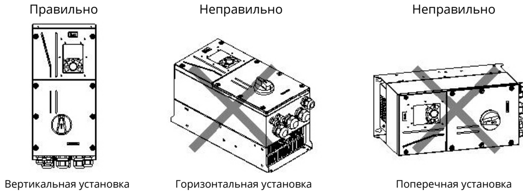
Рис 4.1 Ориентация ПЧ при установке
