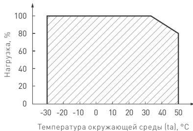
Рис. 2. Максимальная допустимая нагрузка, % от мощности источника
