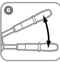
Разрежьте кабель, работая подвижной рукояткой. По окончании работы задвиньте рукоятки.
