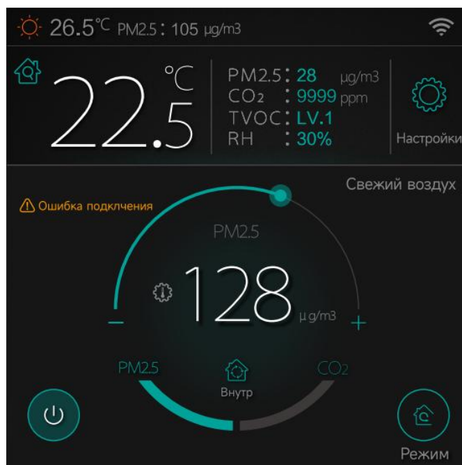
Интерфейс управления приточной установкой
