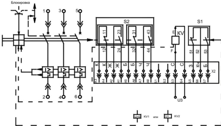
**Рисунок Г.8** - Схема электрическая принципиальная выключателей выдвижного исполнения, с нулевым или минимальным расцепителем напряжения, вспомогательными контактами сигнализации автоматического отключения, вспомогательными контактами
