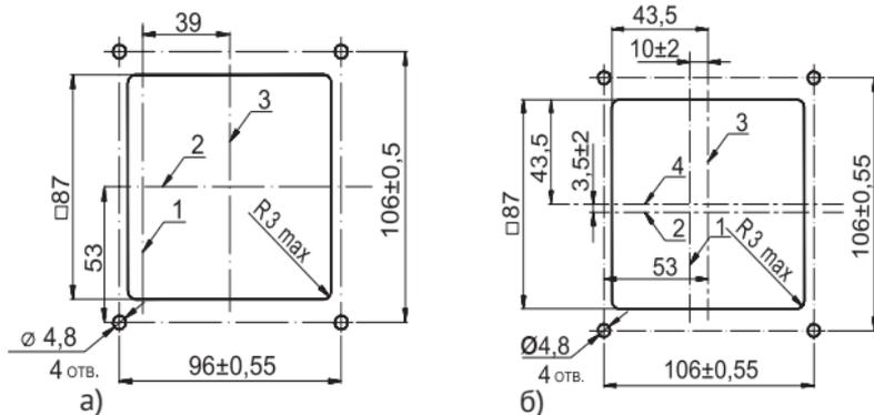
1 - вертикальная ось выключателя; 2 - горизонтальная ось выключателя; 3 - вертикальная ось ручного дистанционного привода; 4 - горизонтальная ось ручного дистанционного привода;
