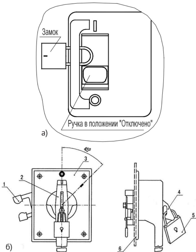
**Рисунок Б.14** – Запирающее устройство в положении «Отключено»
