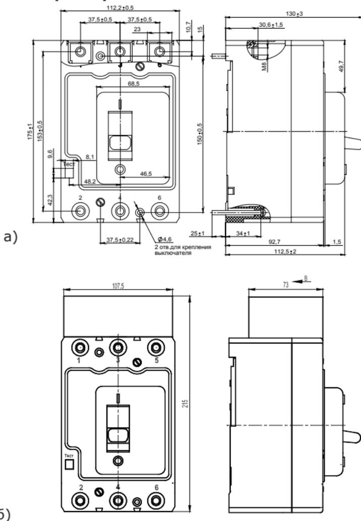
**Рисунок Б.1** - Выключатель ВА57-35 (ВА57Ф35) с зажимами для переднего присоединения
