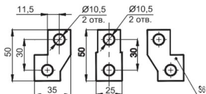
**Рисунок Д.2** – Комплект дополнительных расширительных присоединительных выводов
