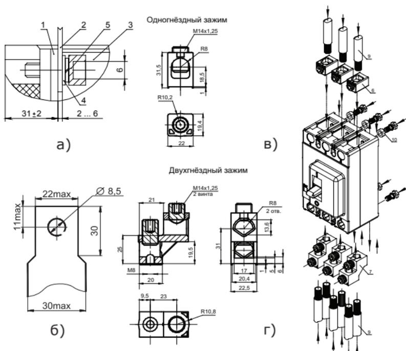
**Рисунок Д.1** – Способы присоединения внешних проводников к выключателю:
