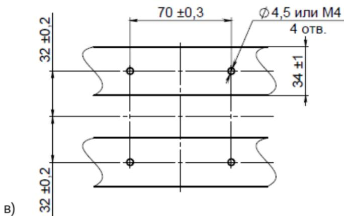
**Рисунок Б.12** - Расположение отверстий для крепления втычной панели
