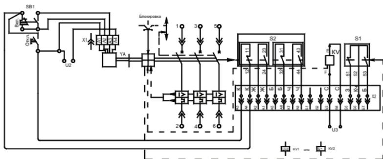
**Рисунок Г.7** - Схема электрическая принципиальная выключателей выдвижного исполнения, с нулевым или минимальным расцепителем напряжения, вспомогательными контактами сигнализации автоматического отключения, вспомогательными контактами и электромагнитным приводом
