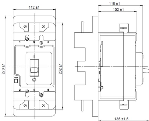
**Рисунок Б.10** - Выключатель ВА57-35 на втычной панели
