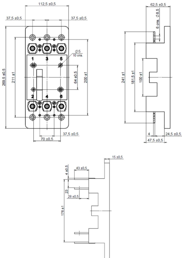
**Рисунок Б.9 - Панель втычная ВА57-35**
