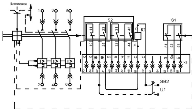
**Рисунок Г.6** - Схема электрическая принципиальная выключателей выдвижного исполнения, с независимым расцепителем, вспомогательными контактами, вспомогательными контактами сигнализации автоматического отключения
