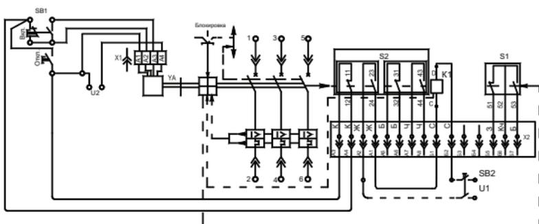
**Рисунок Г.5** - Схема электрическая принципиальная выключателей выдвжного исполнения, с независимым расцепителем, вспомогательными контактами, вспомогательными контактами сигнализации автоматического отключения и электромагнитным приводом
