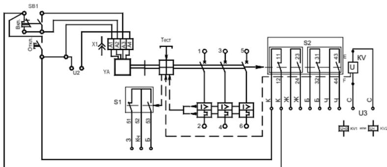
**Рисунок Г.4** - Схема электрическая принципиальная выключателей стационарного исполнения, с нулевым или минимальным расцепителем напряжения, вспомогательными контактами сигнализации автоматического отключения, вспомогательными контактами и электромагнитным приводом, аналогично для втычного присоединения
