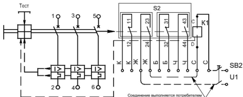
**Рисунок Г.2** - Схема электрическая принципиальная выключателя стационарного исполнения, переменного тока трехполюсного исполнения с независимым расцепителем и вспомогательными контактами, аналогично для втычного присоединения
