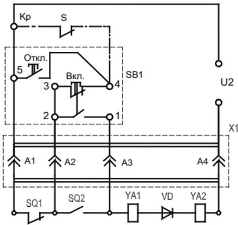
**Рисунок Г.9** - Электрическая принципиальная схема привода электромагнитного
