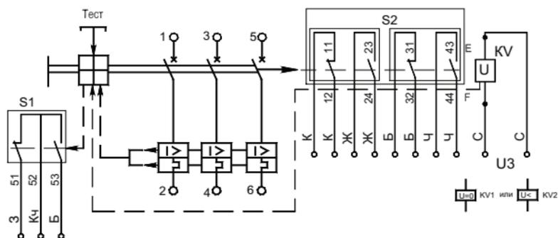
**Рисунок Г.3** - Схема электрическая принципиальная выключателей стационарного исполнения, с нулевым или минимальным расцепителем напряжения, вспомогательными контактами сигнализации автоматического отключения и вспомогательными контактами, аналогично для втычного присоединения
