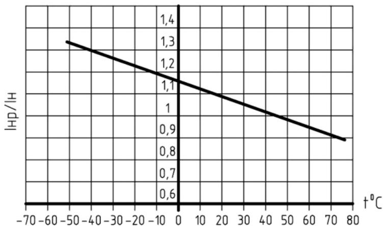
**Рисунок А.8** - Зависимость номинального рабочего тока выключателей с приемкой РС от температуры окружающего воздуха
