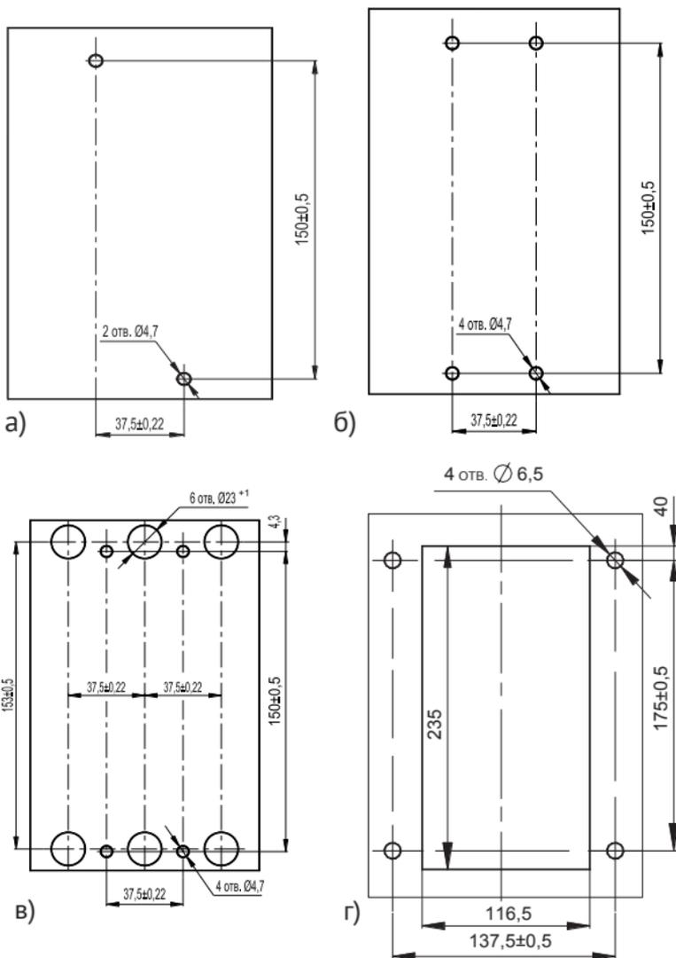
**Рисунок Б.4** - Расположение отверстий для крепления выключателя
