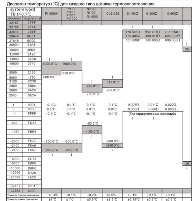
Характеристики термосопротивления: диапазон температур и точность каждого типа датчиков термосопротивления (OF – макс. значение диапазона, OR – верхняя граница диапазона, NR – номинальный диапазон, UR – нижняя граница диапазона, UF – мин. значение диапазона)
