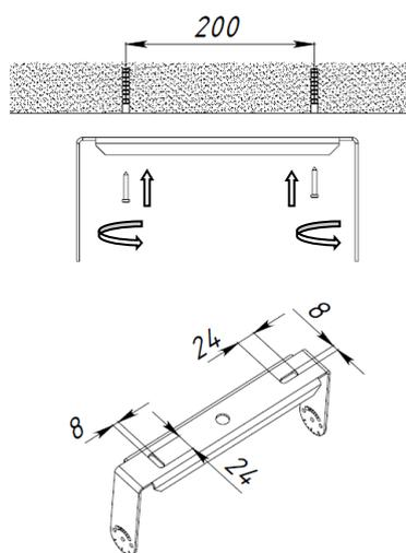
2. Закрепить светильник на лире (кронштейне) выставить нужный угол и зафиксировать. Момент затяжки 8,5-9 Нм.
