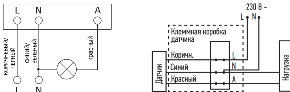
Рисунок 4. Схема подключения датчика.
