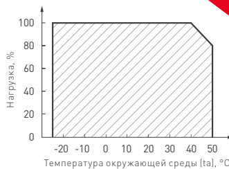
Рисунок 6. Максимальная допустимая нагрузка, % от мощности источника
