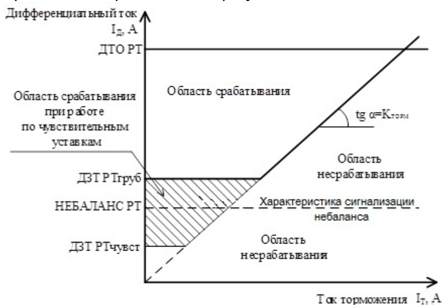
Рисунок 4 - Характеристика срабатывания дифференциальных защит
