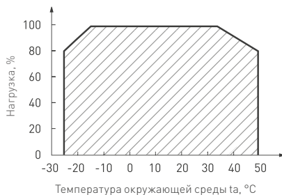
Рис. 2. Максимальная допустимая нагрузка, % от мощности источника
