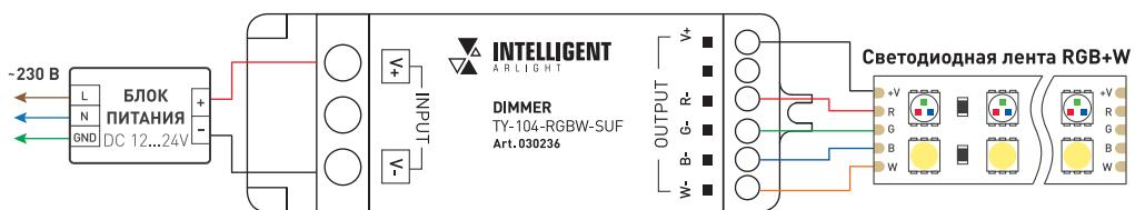
Рисунок 3. Пример схемы подключения диммера TY-104-RGBW-SUF
