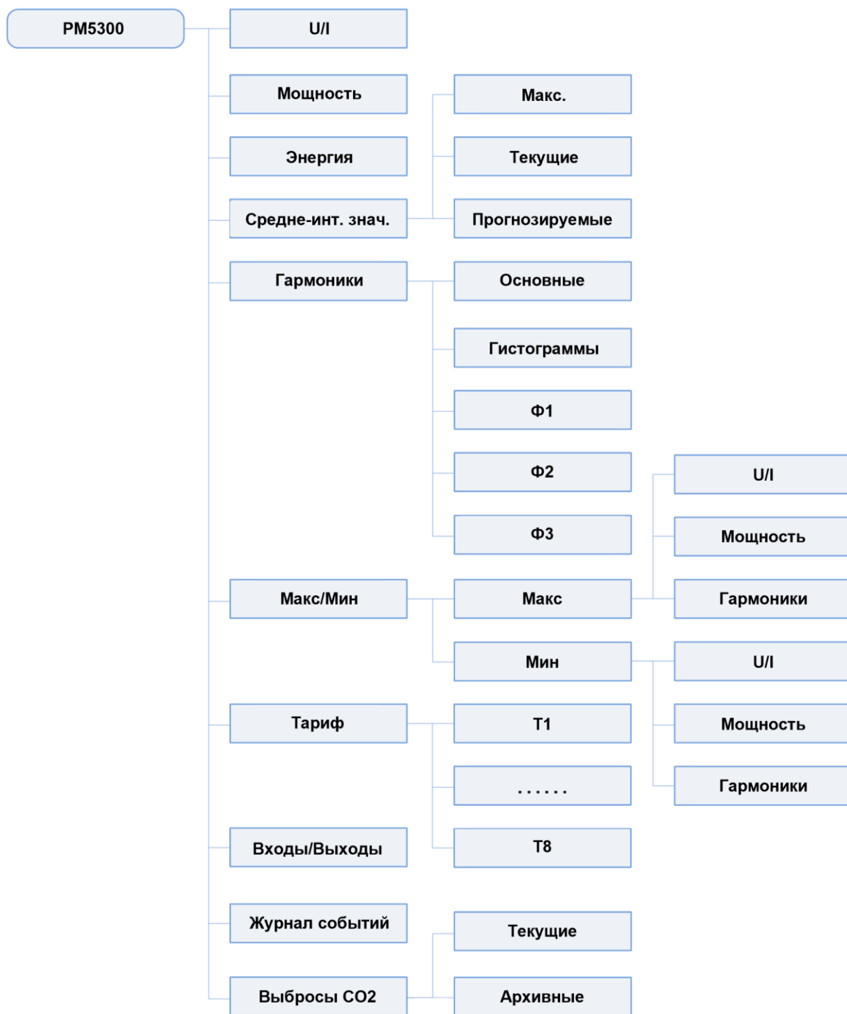
Рисунок 4.1.2 Структура меню счётчика PM5300
