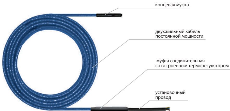
Рис. 1. Конструкция нагревательной секции
