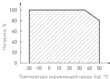
Рис. 2. Максимальная допустимая нагрузка, % от мощности источника
