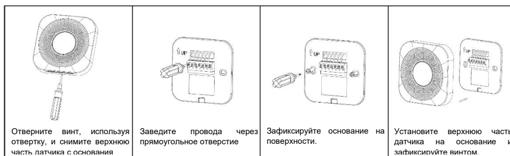
Порядок установки датчика качества воздуха
