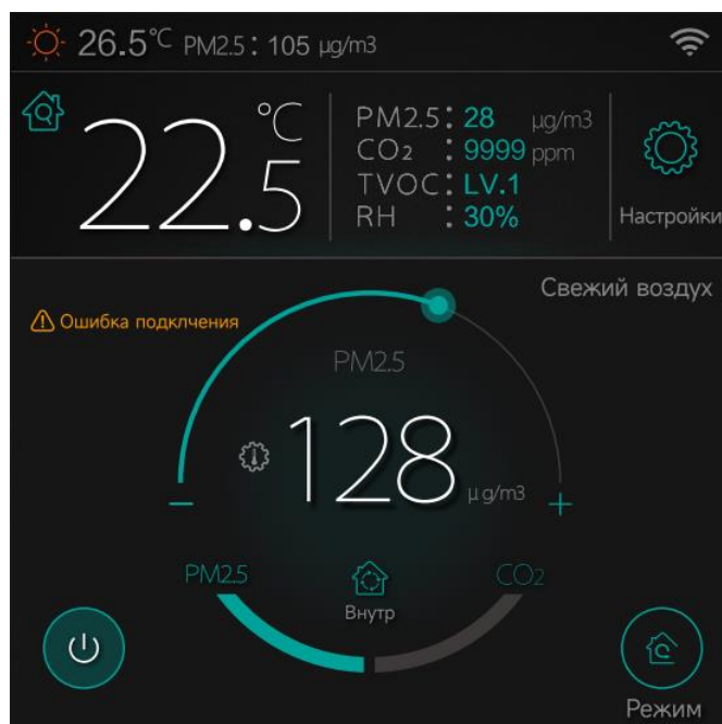
Интерфейс управления приточной установкой
