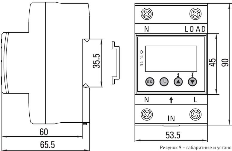
Рисунок 9 – габаритные и установочные размеры
