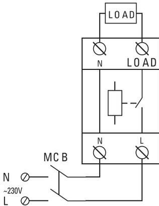
Рисунок 7 – Условная схема подключения
