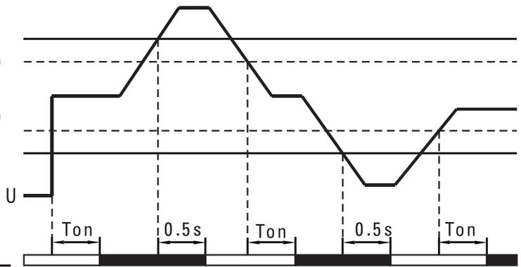
Рисунок 1 – Диаграмма работы реле напряжения
