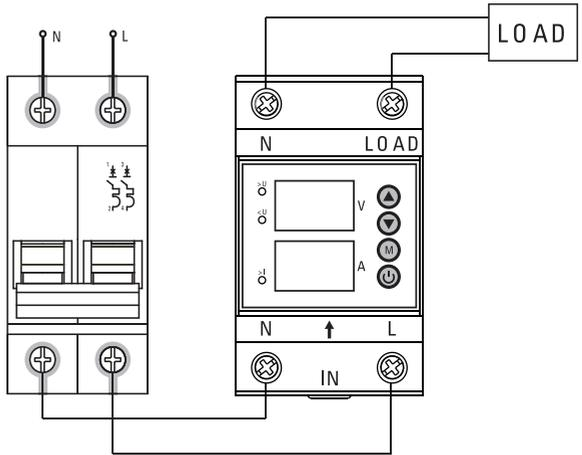
Рисунок 7 – Условная схема подключения
