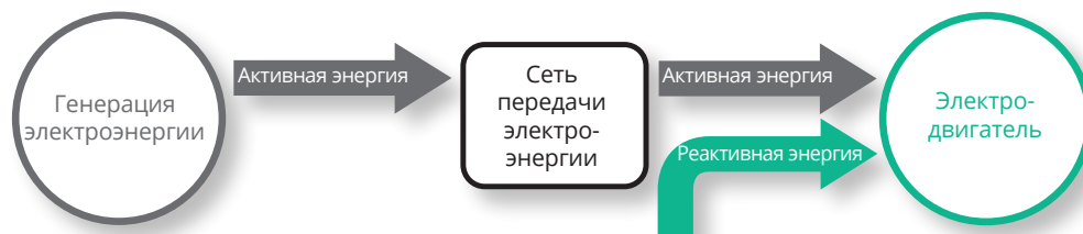
Реактивная энергия производится конденсаторами. Энергосбытовая компания не выставляет счет за реактивную энергию.
