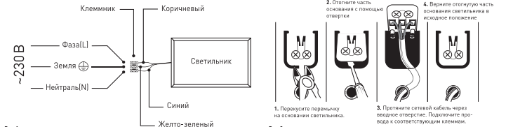
Рис.1. Схема подключения светильника SPO-7-50/ SPO-7-72 к сети 230В. Рис.2. Отгнийте часть основания в помощной отвертки
