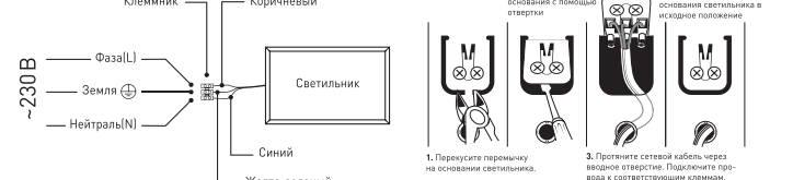
Рис.1. Схема подключения светильника SPO-7-50/ SPO-7-72 к сети 230В. Рис.2. Дұрыс жалғануын тексергеннен кейін, желілік кернеуді қосуға болады.
