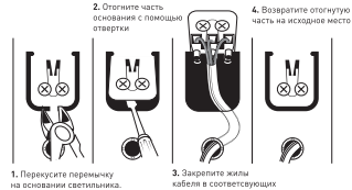
Рис.1. 230В шамчыракты токко туташтыруу схемасы
