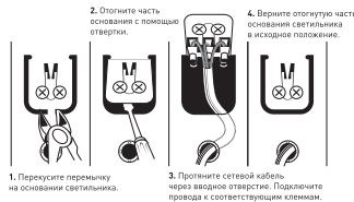
Рис.1. Схема подключения светильника к сети 230В.
