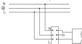
2. Схема подключения светильника с датчиком движения (MS) к питающей сети.
