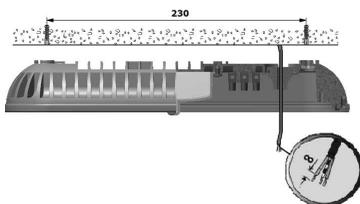
5. Закріпити корпус на поверхні стелі за допомогою комплекту кріплення Х5 (не входить в комплект поставки), попередньо вдягнувши на гвинти гумові шайби (входять в комплект поставки). Для світильників з датчиком руху висота установки становить 1,5 - 3,5 м.
