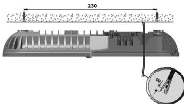
5. Закрепить корпус на поверхности потолка с помощью комплекта крепежа X5 (не входит в комплект поставки), предварительно надев на винты резиновые шайбы (входят в комплект поставки). Для светильников с датчиком движения высота установки составляет 1,5 – 3,5 м.
