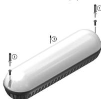
3. Открутить два винта (1) и снять пластик/светодиодный кластер (2) (не касаясь и не повреждая светодиодов).
