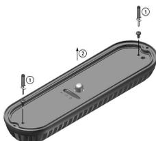
4. Провести сетевые провода через проходной изолятор в корпус светильника и зачистить на 8 мм<sup>2</sup>
