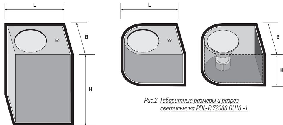
Рис.2 Габаритные размеры и разрез светильника PDL-R 72080 GU10 -1
