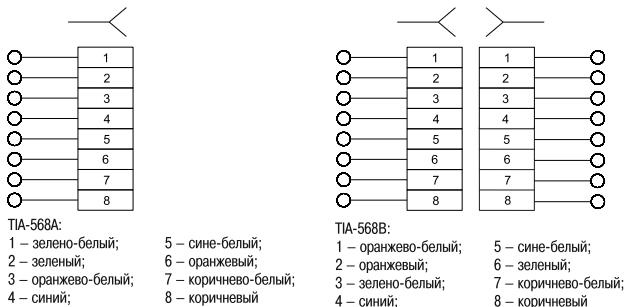
Рисунок 2 – электрическая схема компьютерных розеток РК10-ВБ, РК10-2-ВБ
