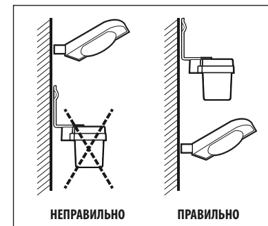
Рис 1. Схема установки фотореле
