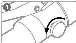
Поверните винт сброса давления в положение «Открыто».
