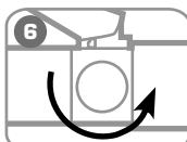
Поверните винт сброса давления в положение «Открыть».
