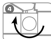
Поверните винт сброса давления в положение «Закрыть».
