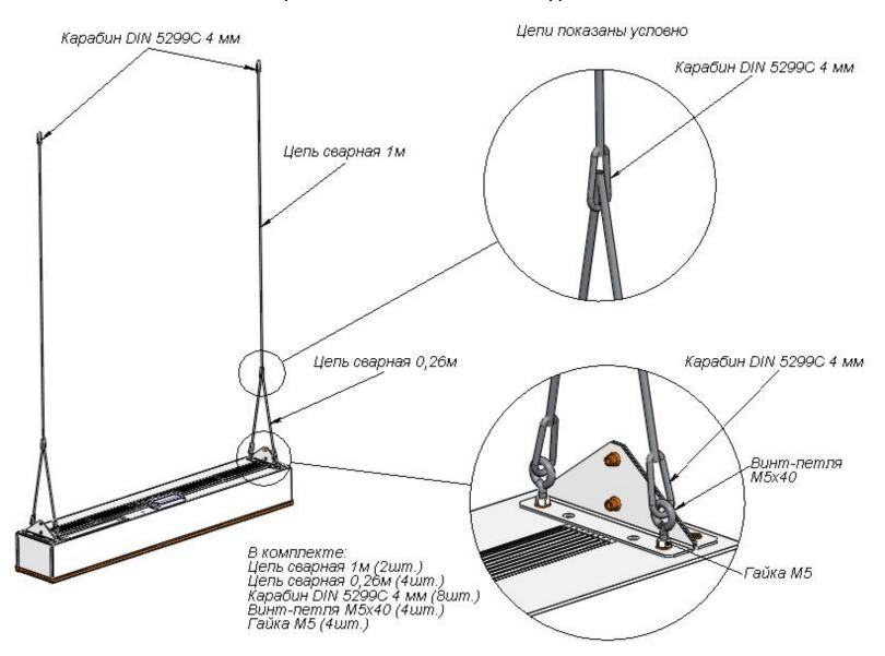
При необходимости компенсировать разность длин цепей соседних светильников, использовать входящие в комплект гайки М5, накручивая их на винт-петли, тем самым регулируя высоту светильника.
