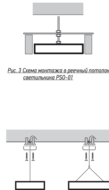
Рис. 4 Схема подвешного монтажа светильника PSO-01
