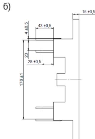
**Рисунок Б.9 - Панель втычка BA57-35**
