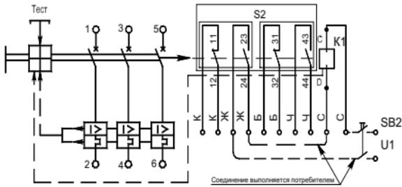
**Рисунок Г.2** - Схема электрическая принципиальная выключателя стационарного исполнения, переменного тока трехполюсного исполнения с независимым расцепителем и вспомогательными контактами
