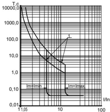
**Рисунок А.6 - Время-токовые характеристики выключателей на ток 160 A, 200 A, 250 A**
