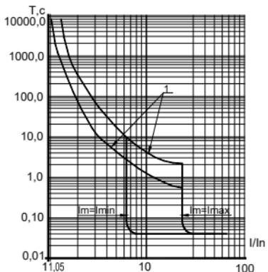
**Рисунок А.5 - Время-токовые характеристики выключателей на ток 125 A**
