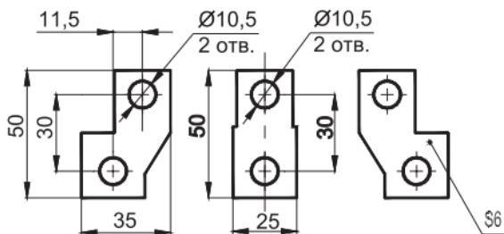
**Рисунок Д.3** – Комплект дополнительных расширительных присоединительных выводов и изолирующий экран
