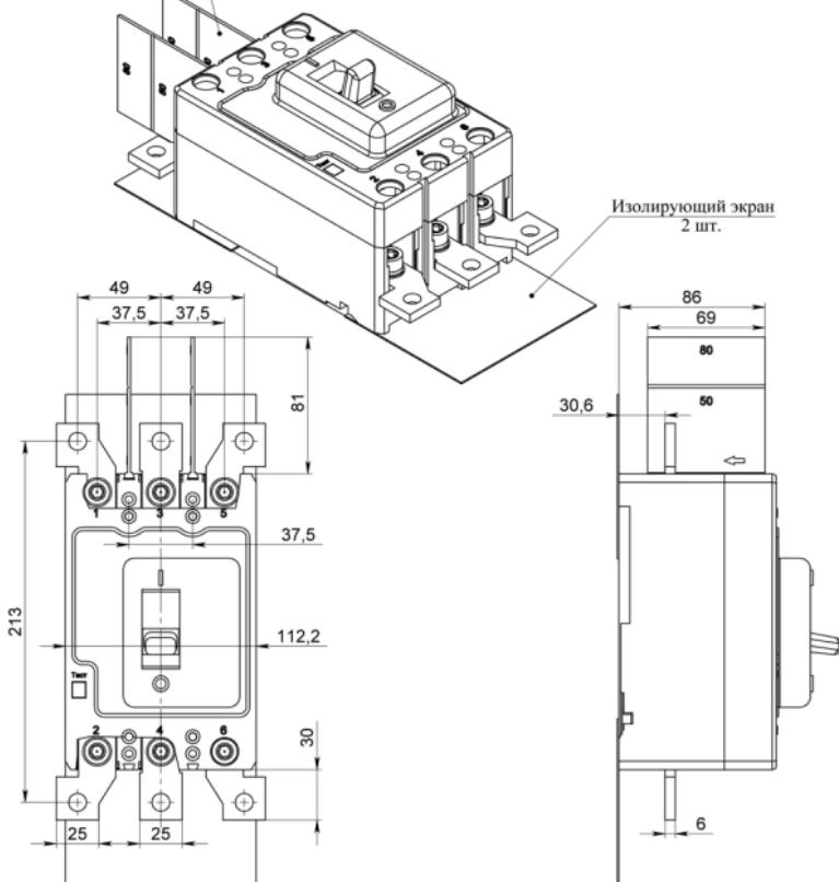
**Рисунок Д.2** – Присоединение с расширительными выводами,
