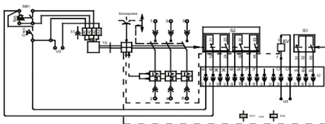
**Рисунок Г.7 - Схема электрическая принципиальная выключателей выдвижного исполнения, с нулевым или минимальным расцепителем напряжения, вспомогательными контактами сигнализации автоматического отключения, вспомогательными контактами и электромагнитным приводом**
