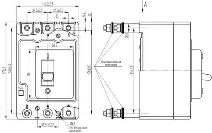
**Рисунок Б.2 - Выключатели ВА57-35 (ВА57Ф35) с зажимами для заднего присоединения**
