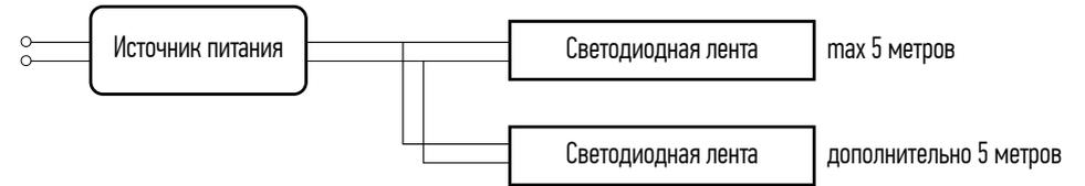
Рис.2 Параллельный монтаж PLS PRO-5
