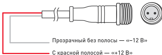
Рис. 2. Кабели питания и управления лентой SPI-PFS-B60
