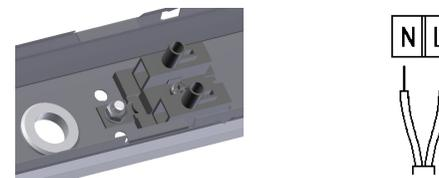
4. Установить в размеченные места корпус на опорную поверхность или подвес.
