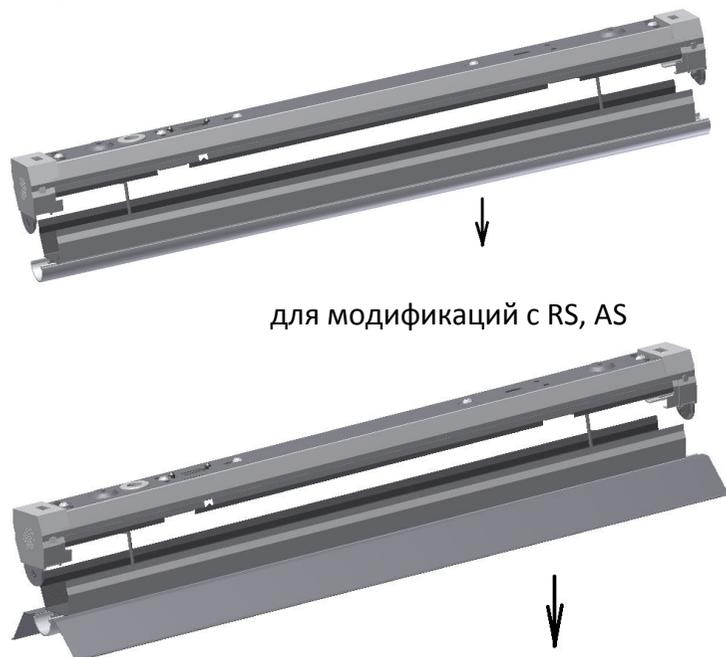
2. Разметить место для установки корпуса светильника.
