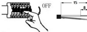
4. Підключити мережевий провід до клемної колодки світлодіодного драйвера згідно схеми, дотримуючись умов полярності: «L» - фаза, «N» - нуль, попередньо відкрутивши захисну кришку. Встановити та закрутити захисну кришку на драйвер.
