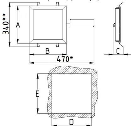
2. \*\*Наибольший габарит установленного светильника (зависит от толщины потолка)
