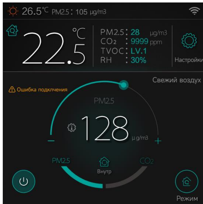
Интерфейс управления приточной установкой
