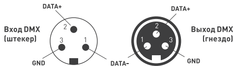
Рис. 1. Схема подключения и цветовая маркировка проводов.
